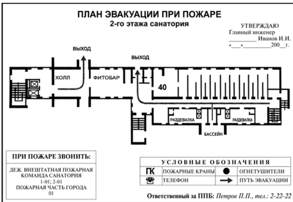
Рис. 4.1. Типовой план эвакуации объекта
